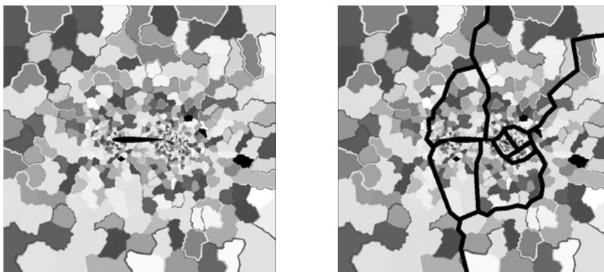
Рис. 1. Иерархическое представление двумерной сетки
